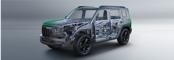
5 зірок A/E-NCAP 2026 — максимальний рівень безпеки завдяки сталі до 2000 МПа в ключових зонах кузова
